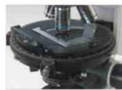
高精度圆形旋转载物台，台面大、旋转方便。装有复式机械移动尺，能够控制样品的细微移动。
